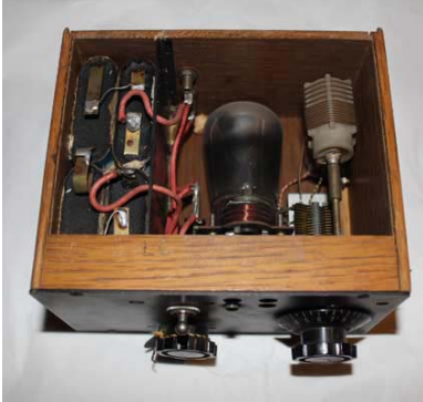
Radio-récepteur de fabrication artisanale avec lampe sur batteries, utilisé par la résistance, ca. 1942.
